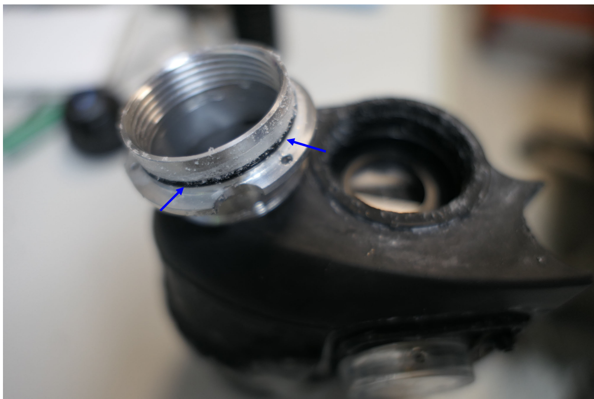
鏡筒拆開內部圖(密封墊圈)
